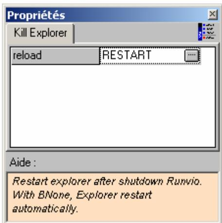
**Reload** : Ce paramètre permet d'autoriser ou non le redémarrage de l'Explorer Windows à la fermeture de votre application. Si le paramètre Reload est égal à 'True' ou si la variable BNone est associée à ce paramètre, l'Explorer Windows est relancé à la fermeture de l'application.
