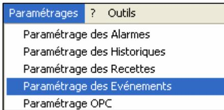
Une grille de paramétrage apparaît permettant de programmer des évènements . Les évènements sont assimilables aux alarmes. Cependant un évènement peu générer une action simple ou complexe. Les évènements comme les alarmes sont visualisables en run dans un composant spécial (listbox) . Le résultat de ce paramétrage est contenu dans le fichier PCEVENT.pas et PCEVENT.VPU (compilé).
