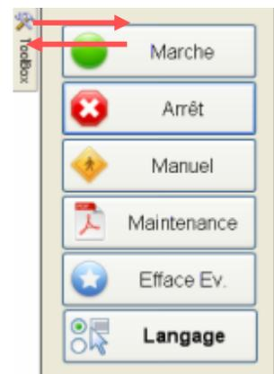
*Ici le synoptique S2 apparaît en glissant de la gauche vers la droite quand l'opérateur passe la souris sur le Bitmap ToolBox. Le synoptique disparaît en glissant vers la gauche lorsqu'il perd le focus*
