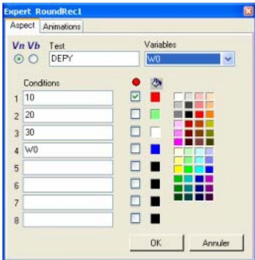
◀ L'autre type de test est une comparaison numérique. Cochez le radio bouton **Vn**, 8 tests sur une variable numérique sont possibles.
