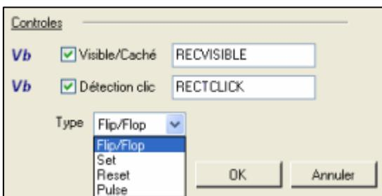
En cliquant dans le rectangle, il est possible de le transformer en bouton de type Pulse, reset, Set ou Flip/Flop.
